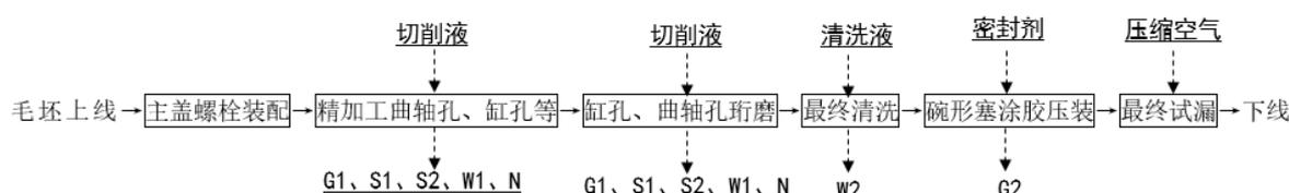
图中：G1-油雾、少量非甲烷总烃；G2-少量非甲烷总烃；W1-废切削液；W2-废清洗液；S1-废金属屑；S2-磨泥；N-噪声
