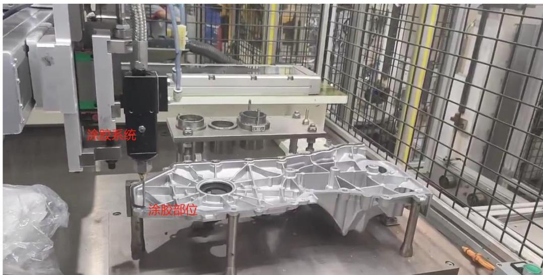
图 3-8 涂胶工序图（现有工程）
